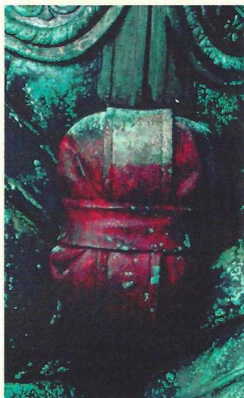
Der Wachsaufrag bindet auch die hellgrünen, pulverförmigen Korrosionsprodukte, welche somit nicht mehr von Witterungseinflüssen abgetragen werden können. Zumindest geringe Unebenheiten in korrodierten Oberflächenbereichen werden durch das Wachs aufgefüllt und ausgeglichen, sodass die Oberfläche nach dem Erkalten und Aushärten des Wachses glatter erscheint. Ein weiterer positiver Aspekt des Wachses ist dessen
